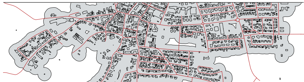
Abbildung 25: Beispielhafte Ermittlung der Fernwärmenetzlängen für ein Einzelgebiet mittels GIS (eigene Darstellung nach (LDBV 2019; OpenStreetMap 2019))
