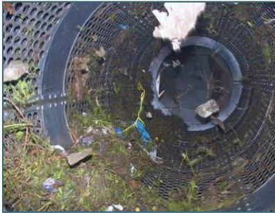
Abb. 29: In der Siebtrommel wird der Müll aussortiert.
