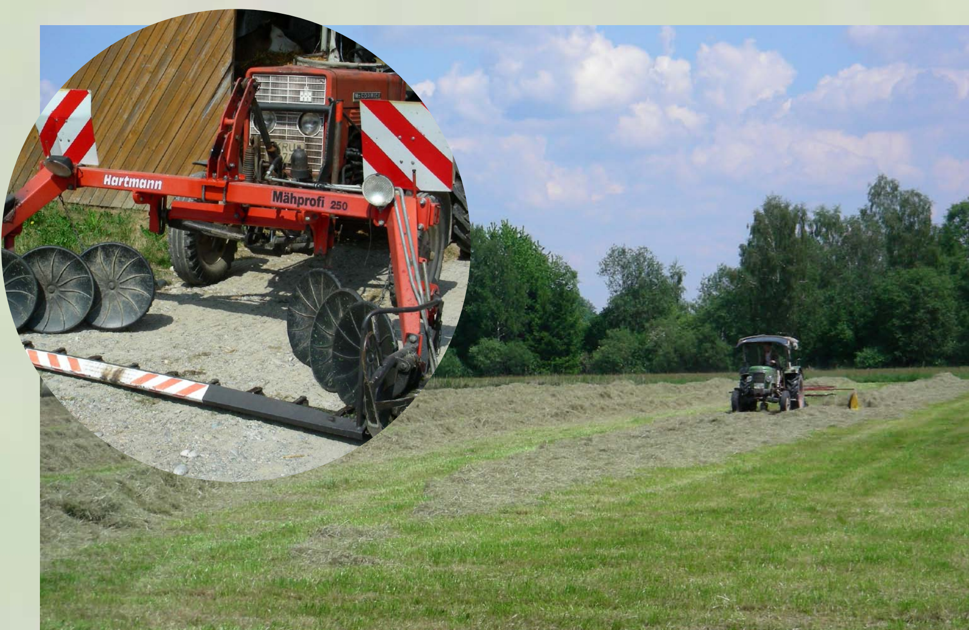
Das Doppelmessermähwerk, eine Spezialanfertigung mit 2,5 m Mähbreite, schont die Tierwelt mehr als der übliche Kreiselmäher.
