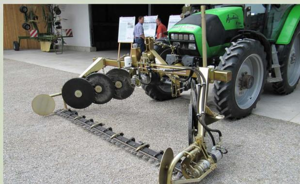
Das Doppelmessermähwerk, hier eine Spezialanfertigung mit 2,5 m Mähbreite, schont die Tierwelt mehr als der übliche Kreiselmäher.
