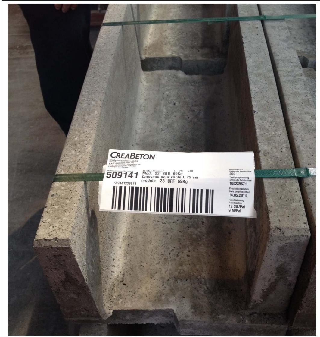
Abbildung 11 zeigt neugegossene Kabelkanal-Elemente in der Betonfabrik Creabeton; diese Kanäle werden vom RBS standardmässig eingesetzt.
