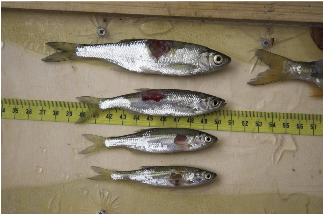
Lauben nach der Passage einer Francisturbine eines Kleinkraftwerks (Foto: Tombek)
